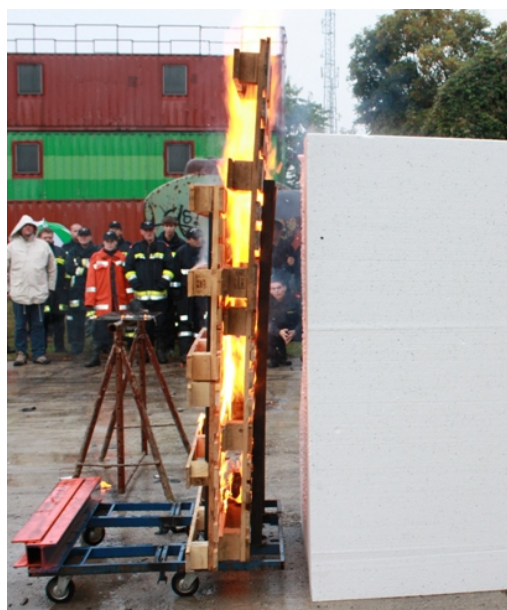
Obrázok: Horiace drevené palety pred blokom EPS
