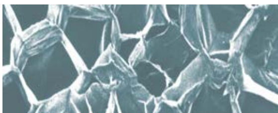
Obrázok: bunková štruktúra EPS pod mikroskopom
