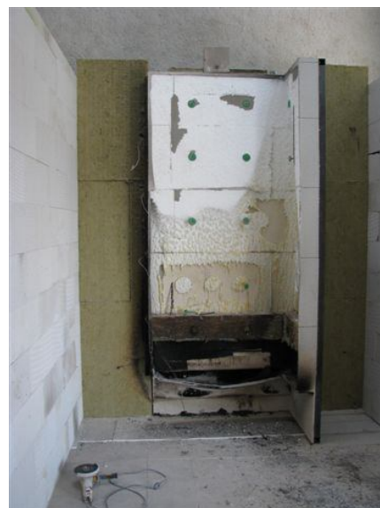
Obrázok č.4:záber na vzorku ETICS po ukončení skúšky podľa ISO 13785-1 a odstránení vrstvy konečnej povrchovej úpravy
