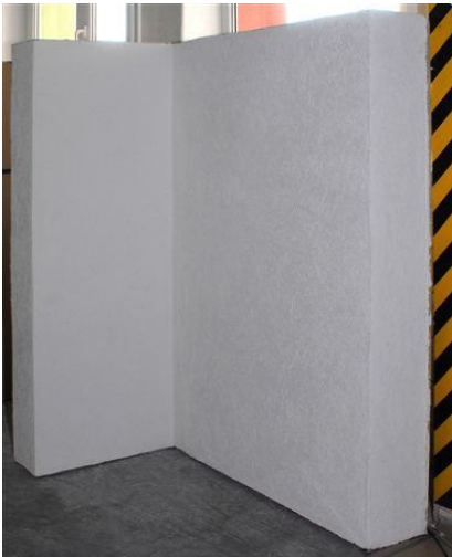
Obrázok č.2: Záber na vzorku na skúšku podľa STN EN 13823 pred začiatkom skúšky
