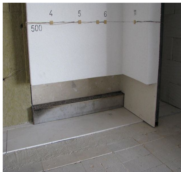
Obrázok č.1 Záber na spodnú hranu vzorky na skúšku podľa ISO 13785-1 pred začiatkom skúšky,
