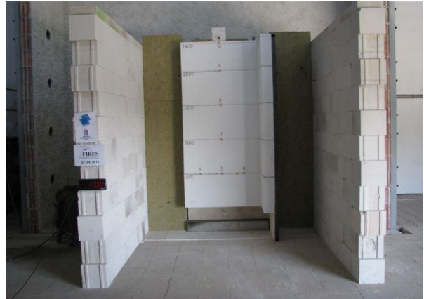
Obrázok č.3 Záber na vzorku na skúšku podľa ISO 13785-1 pred začiatkom skúšky
